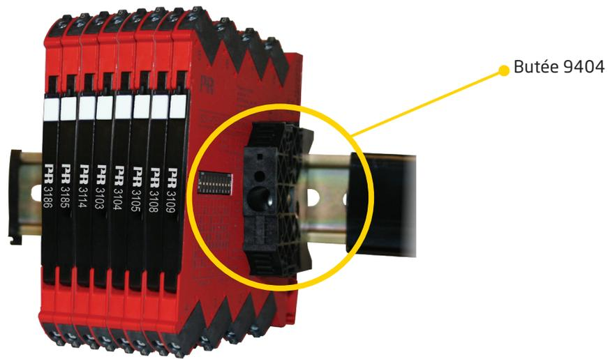
Dans les applications marines le 3186 doit être supporté par des butées (référence PR 9404).
